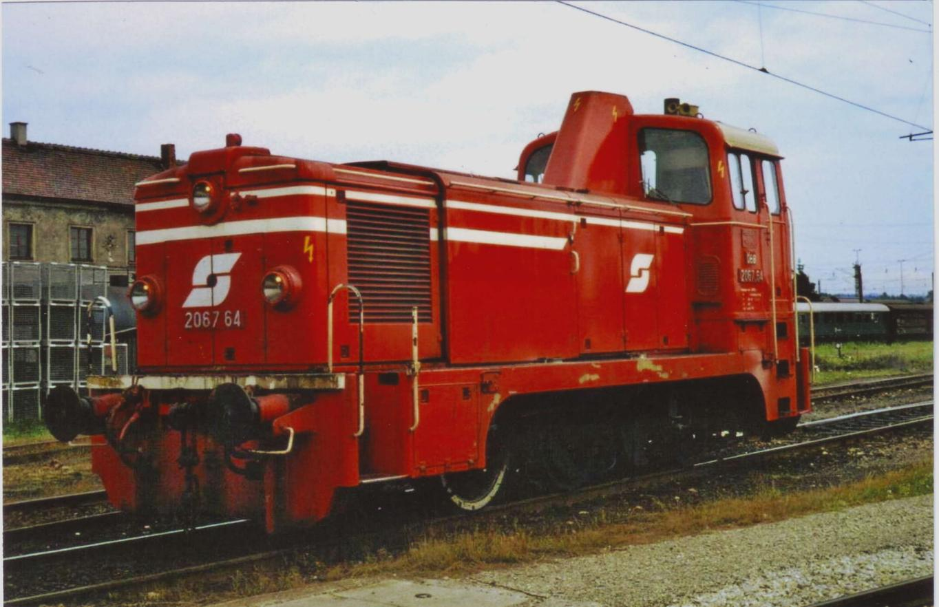
o.: Diesellokomotive für den Verschub und leichten Streckendienst, Reihe ÖBB 2067, Bj. 1959-1978, erzeugt wurden 111 Loks, der ältere Teil wurde bereits ausgemustert.
